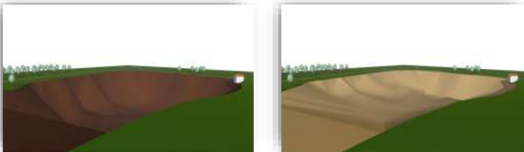
Abb. 3: Darstellung des Weiherbeckens ohne Schlamm (links) und mit Schlamm (rechts). Die Darstellungen sind 10-fach überhöht (aus Stöckli 2007).
