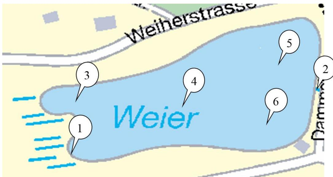
*Abb. 11: Messpunkte im Bellacher Weiher. Nr. 1 ist der Zufluss und Nr. 2 der Abfluss*
