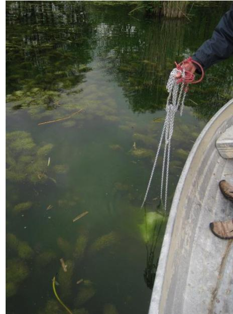
Mit der sogenannten Secchi-Scheibe wird die Sichttiefe bestimmt. Die Scheibe wird ins Wasser gelegt und bis zu dem Punkt herabgelassen, an dem sie für das menschliche Auge gerade noch knapp zu sehen ist.
