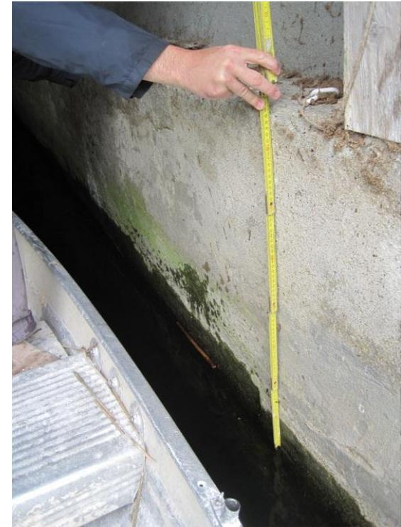
Der Wasserstand wird an einem festen Referenzpunkt abgenommen. Je nach Wasserstand müssen die Resultate zur Tiefe und Sichttiefe angepasst werden.
