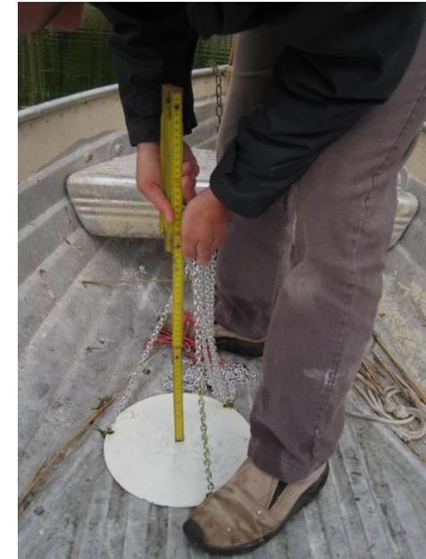
Diese Tiefe kann dann mit einem Massstab anhand der Kettenlänge gemessen werden. Dies ist dann die Secchi-Tiefe.
